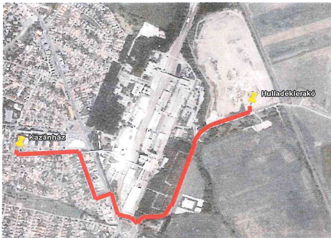
3. ábra: A kazánházig kiépített gázvezeték nyomvonala
