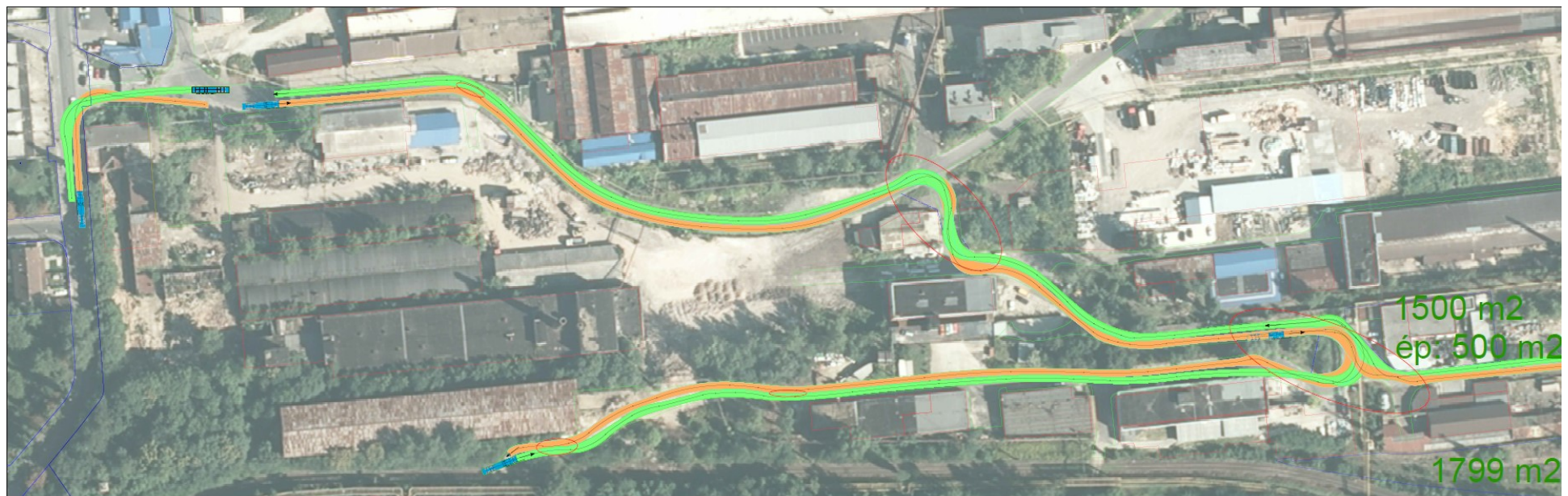
Részlet a Járhatósági vizsgálati tervből – modellezési terv pótkocsis kamion figyelembevételével.
