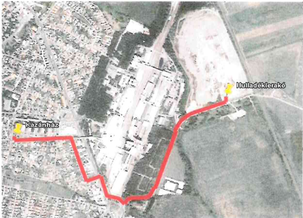
3. ábra: A kazánházig kiépített gázvezeték nyomvonala
