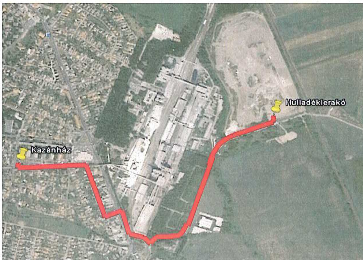
3. ábra: A kazánházig kiépített gázvezeték nyomvonala
